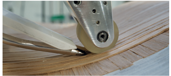
① AG107-Aplicação Deposição de fita
